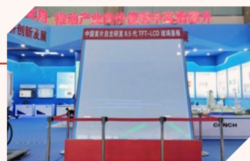
国内首片 8.5 代 TFT-LCD 超薄浮法玻璃基板
